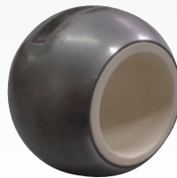
ボール： メテコ16C+タングステン合金溶射 のボールにセラミック内筒接着
